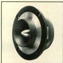
HTR 320: Hoog belastbare ringradiator met uitstekende geluidskwaliteit voor studiomonitors en PA. Zeer breed en lineair frequentieverloop, hoge werkingsgraad, nominale belastbaarheid 20 watt, muziekbelastbaarheid 300 watt.* *Optimale scheiding 7500 Hz, 12 dB/okt.
